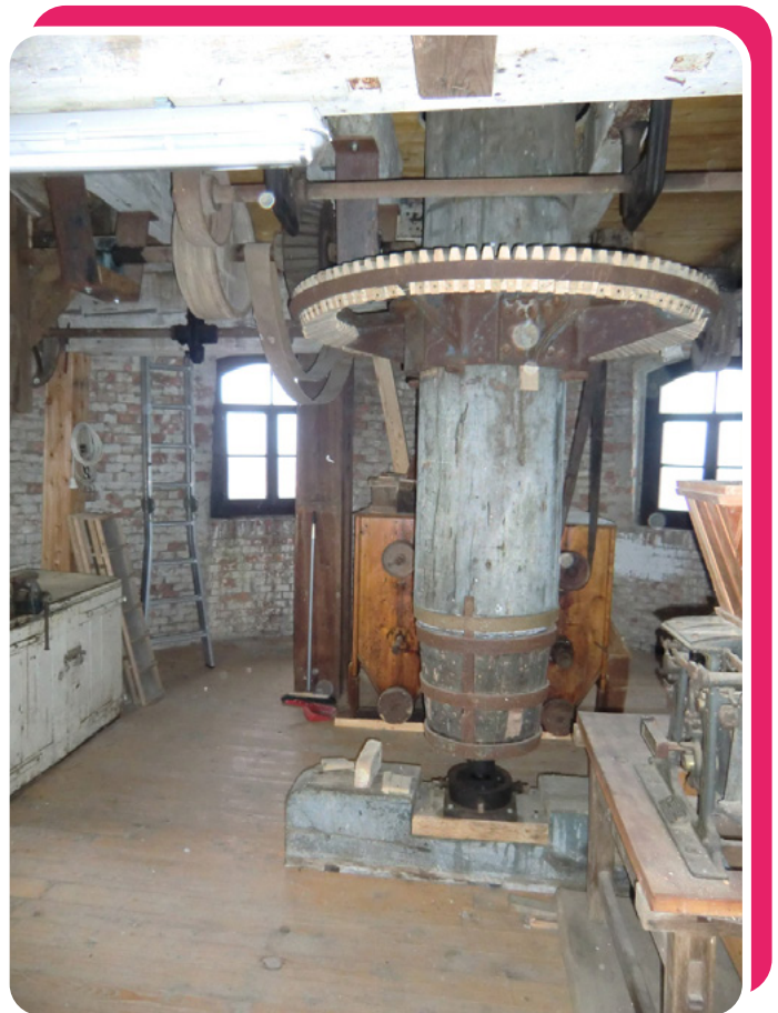
Die drei Mahlgänge wurden vollständig über ein gusseisernes Räderwerk angetrieben, das in Deutschland damals nahezu unbekannt war.
