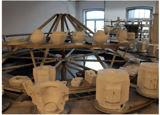
Gießkarussell mit Gipsformen zur Herstellung von Teekannen im „Porzellanikon“ in Selb.
